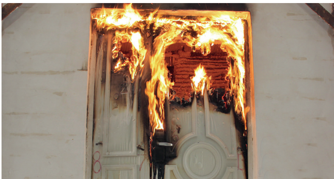
Ensayo de resistencia al fuego
